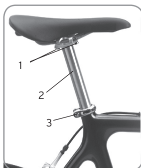
Figure 16. Pièces de la tige de selle
