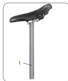
Figure 19. Indicateur d'insertion minimale de la tige de selle
