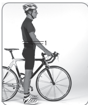
Figure 1. Hauteur en surplomb minimale 1. 25 mm pour la plupart des vélos, 50-75 mm pour les VTT
