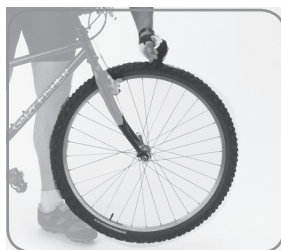
Figure 40. Test pour vérifier la fixation des roues
