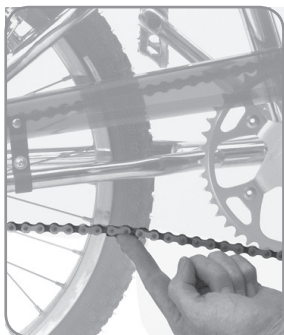
Figure 6. Vérification de la tension de la chaîne
