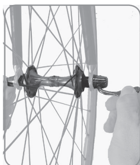
Figure 4. Système de démontage rapide des roues
