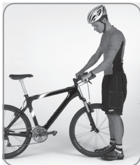
Figure 7. Test fonctionnel du guidon et de la potence
