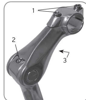
Figure 12. Potence à plongeur à élévation réglable 1. Boulons de serrage du guidon 2. Expandeur 3. Boulon de réglage de l'angle
