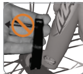
Figure 41. Vérifiez que le levier ne tourne pas
