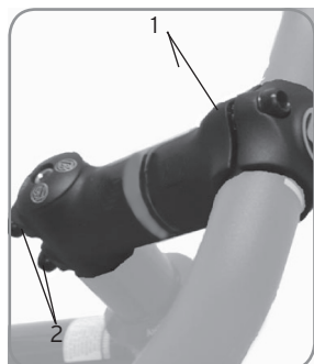
Figure 11. Potence Ahead Set 1. Boulons de serrage du guidon 2. Boulons de serrage du pivot
