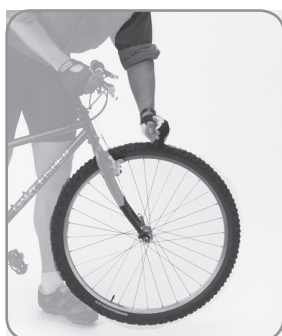
Figure 3. Test pour vérifier la fixation des roues
