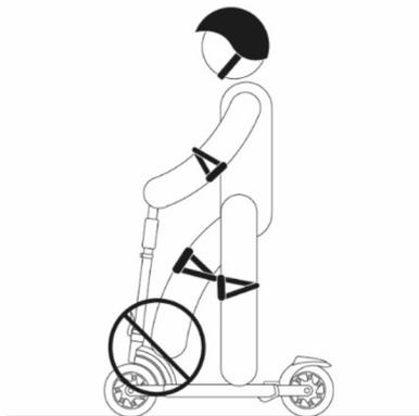
Figura 40 - No colocar el pie en la parte curva del chasis
