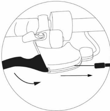
Figura 16 - Instalación del latiguillo de freno de disco 3
