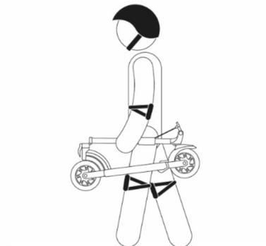
Abbildung 49 - Tragen des Rollers 500 Iride
